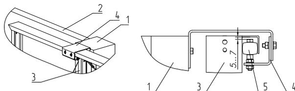
Рис. 51. Установка кронштейна *FLGU.400.0919* (*FLGU.400.0916*) в откатных самонесущих воротах при монтаже ворот без столба удерживающего:
