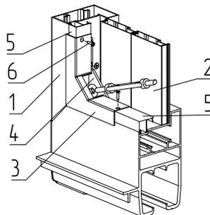
Рис. 30. Установка крышки *FLGU.400.0717*:
