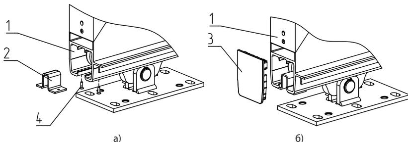
Рис. 40. Установка опор роликовых и ролика опорного:
