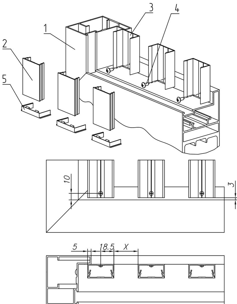
Рис. 23. Встроенный тип монтажа разреженного заполнения профилем 37 мм:
