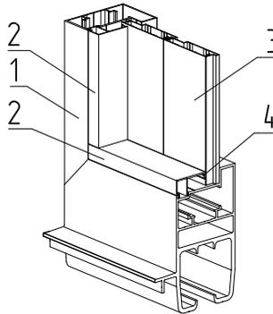
Рис. 29. Установка штапиков с уплотнителем FRK12:
