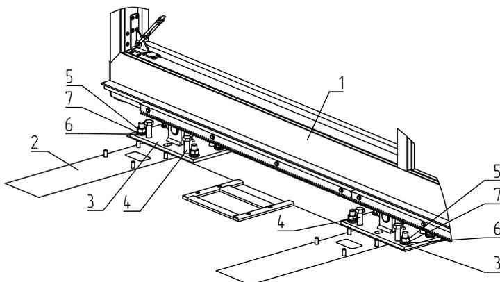
Рис. 45. Установка створки ворот на раму опорную:
