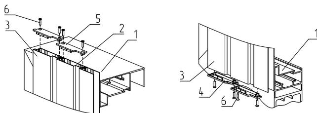
Рис. 34. Установка крышек сплошного заполнения:
