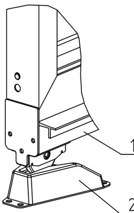
Рис. 66. Установка упора FLGU.400.0933
