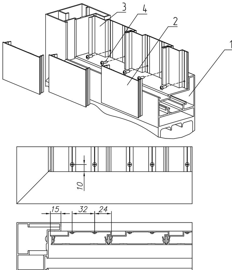
Рис. 28. Встроенный тип монтажа сплошного заполнения:
