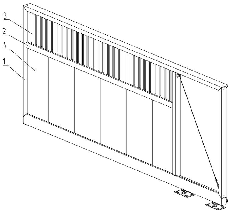
Рис. 35. Створка с комбинированным заполнением:
