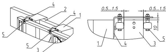
Рис. 50. Установка кронштейна *FLGU.400.0918* в откатных самонесущих воротах при монтаже ворот без столба удерживающего:
