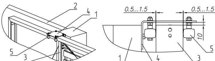
Рис. 49. Установка кронштейна *FLGU.400.0917* в откатных самонесущих воротах при монтаже ворот без столба удерживающего:
