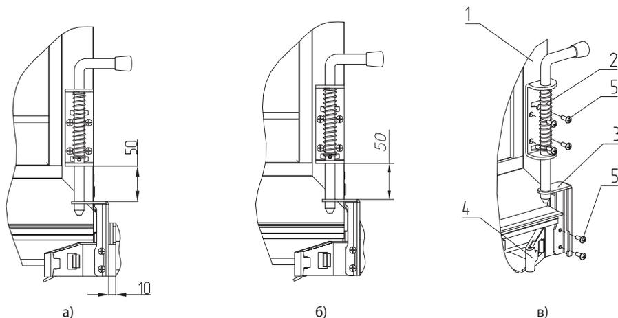
Рис. 58. Установка засова с применением кронштейна FLGU.400.0939(FLGU.400.0940)
