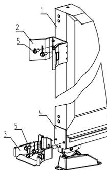
Рис. 67. Установка верхнего и нижнего улавливателей
