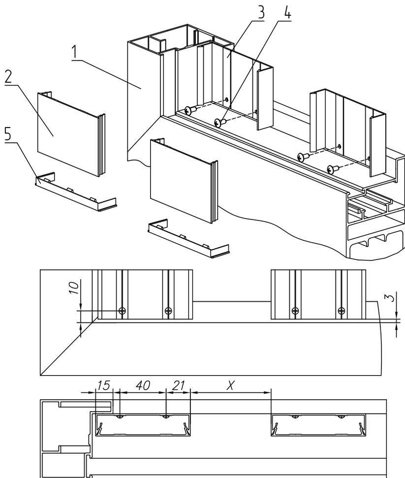
Рис. 22. Встроенный тип монтажа разрезанного заполнения профилем 82 мм:
