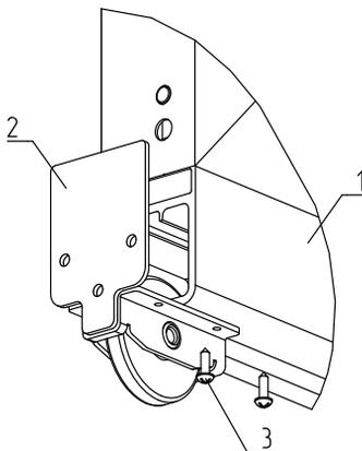
Рис. 65. Установка ролика опорного FLGU.400.0630
