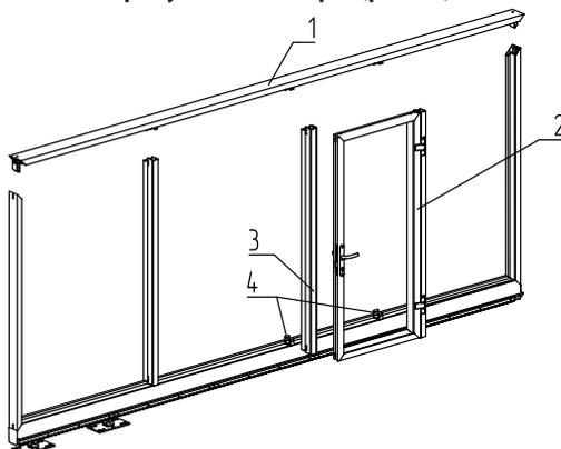
Рис. 61. Установка рамы калитки в створку распашных ворот:
