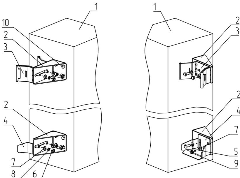
Рис. 53. Установка элементов притвора без столба притвора:
