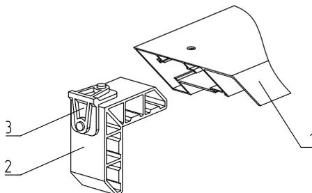
Рис. 6. Установка соединителей угловых в балку:
