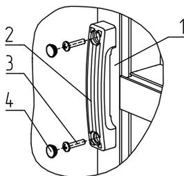
Рис. 57. Установка ручки:
