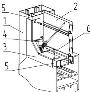
Рис. 20. Установка крышки FLGU.400.0717:
