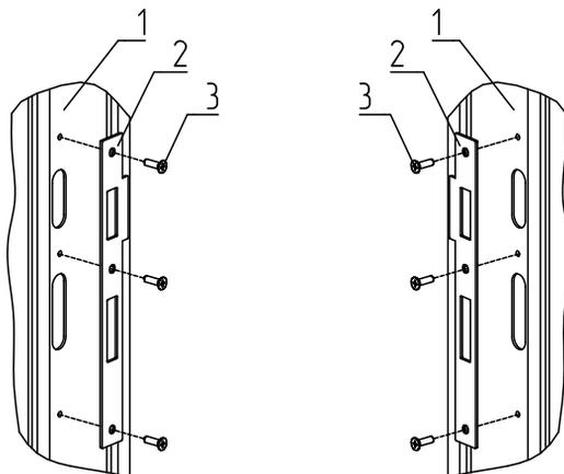
Рис. 63. Установка ответной пластины:
