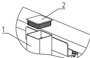
Рис. 48. Установка крышки *FLGU.400.0710*:
