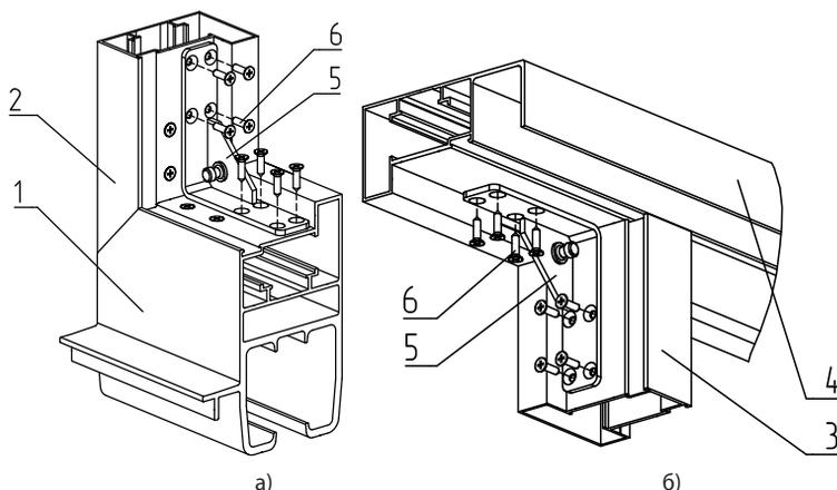
Рис. 12. Установка кронштейнов в технологической части створки:
