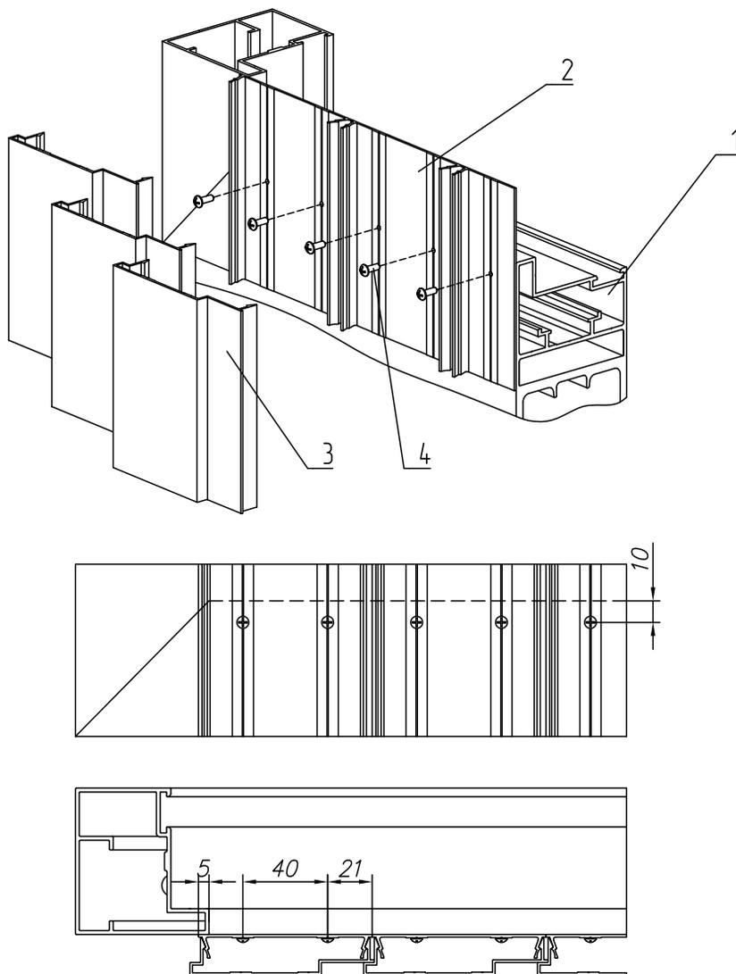
Рис. 31. Накладной тип монтажа сплошного заполнения:
