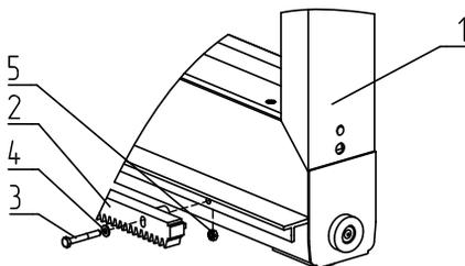
Рис. 44. Установка рейки зубчатой:
