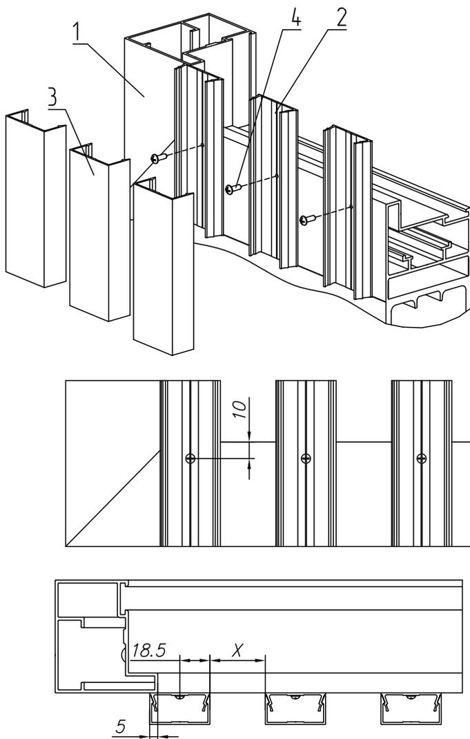
Рис. 26. Накладной тип монтажа разреженного заполнения профилем 37 мм:
