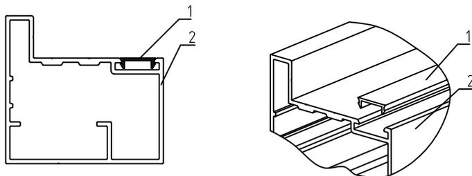
Рис. 42. Установка уплотнителя FLGU.400.0718
