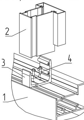
Рис. 4. Установка вертикального импоста:
