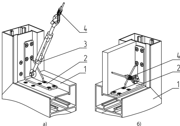
Рис. 37. Установка тросовой растяжки с талрепом:
