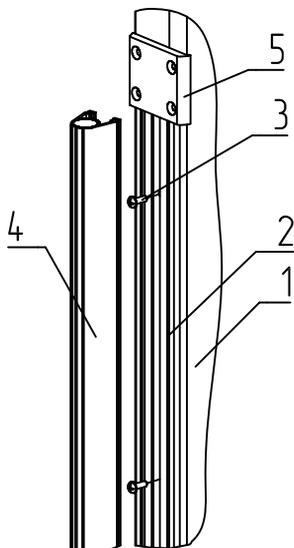
Рис. 43. Установка демпфирующего элемента:
