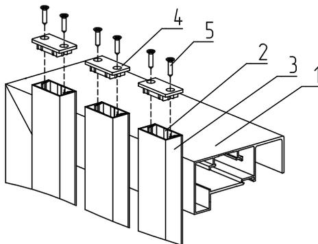
Рис. 33. Установка крышек *FLGU.400.0703*:
