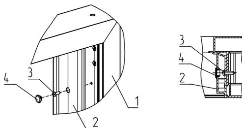
Рис. 62. Установка профиля притвора FLGU.400.0505
