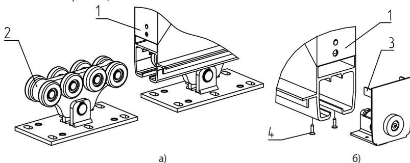
Рис. 39. Установка опор роликовых и ролика опорного:
