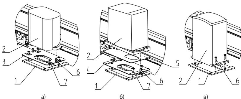
Рис. 56. Установка пластины для крепления электропривода:
