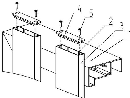
Рис. 32. Установка крышек *FLGU.400.0702*:
