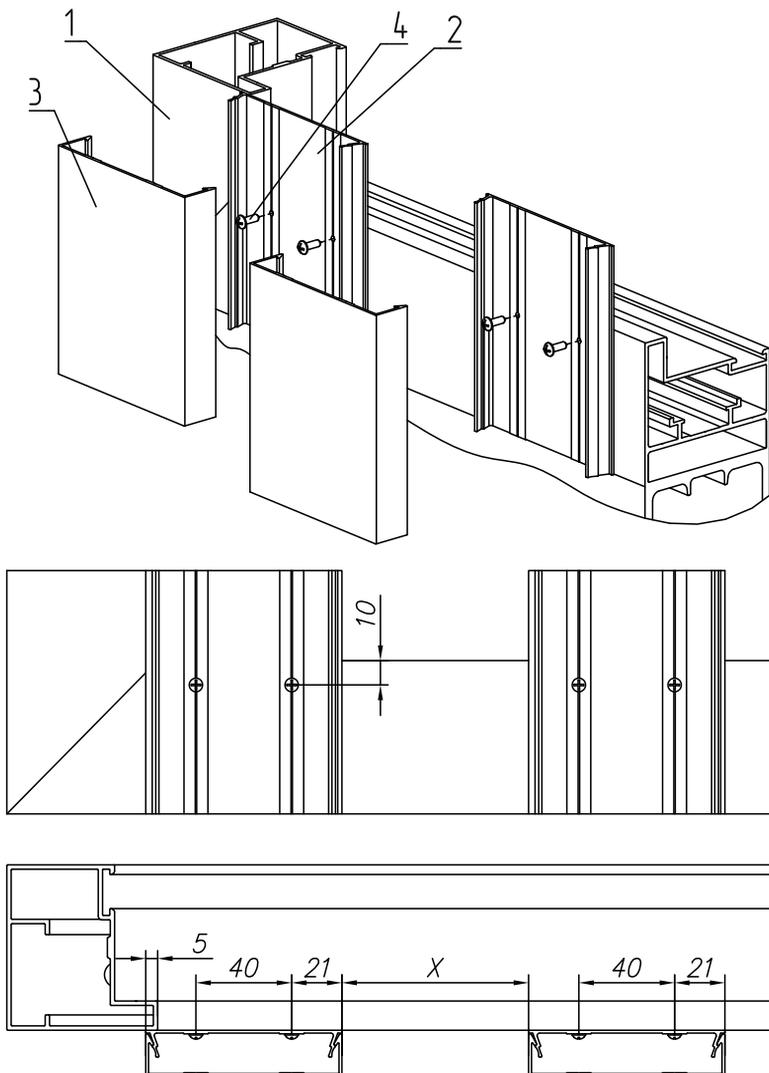
Рис. 25. Накладной тип монтажа разреженного заполнения профилем 82 мм:
