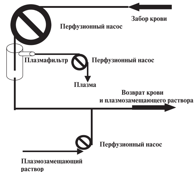
Рис. 2.2. Принципиальная схема системы для плазмафереза
