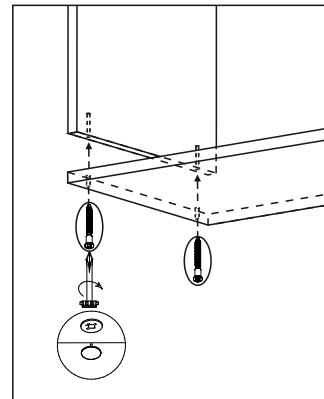
5. Крышку 3 соединить с боковинами при помощи еврошурупов. Ножки прикрепить к нижней крышке 2 при помощи шурупов 3,5\*30 мм.
