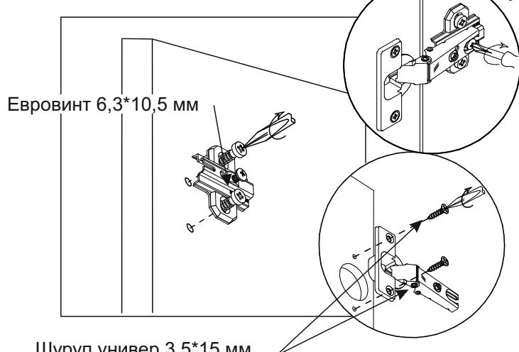
Регулирование зазоров и положения дверей с петлями
