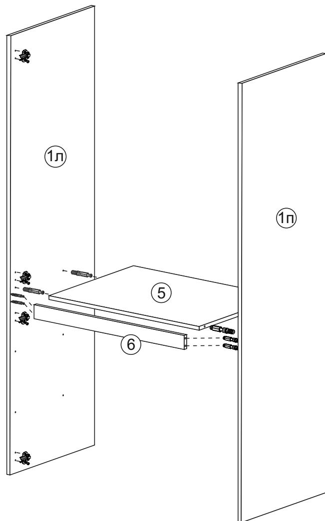
2. Предварительно на боковины 1л и 1п установить эксцентрики и прикрепить ответные планки петель евровинтами 6,3\*10,5 мм.
