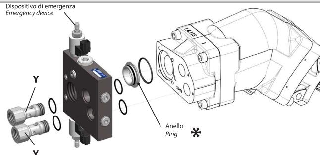
1 - Pulire molto bene le superfici della pompa e della valvola che andranno a contatto. / Clean the pump and by-pass valve surfaces.
