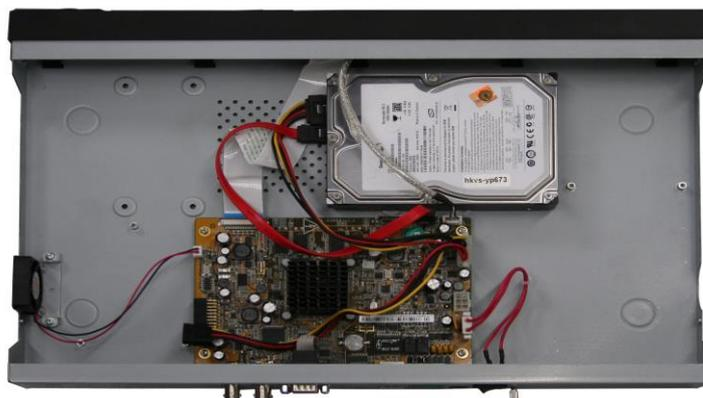
Рисунок 2.9 Закрепление жесткого диска
