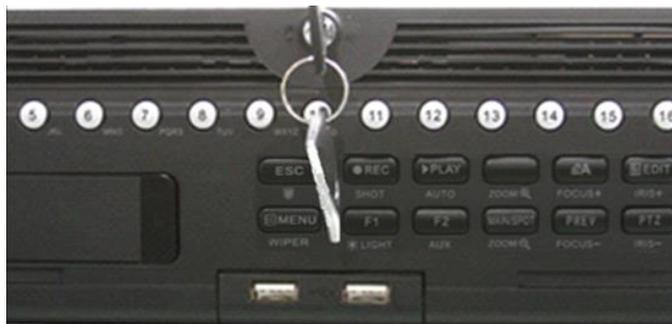
Рисунок 2.2 Вставка ключа в замок на панели
