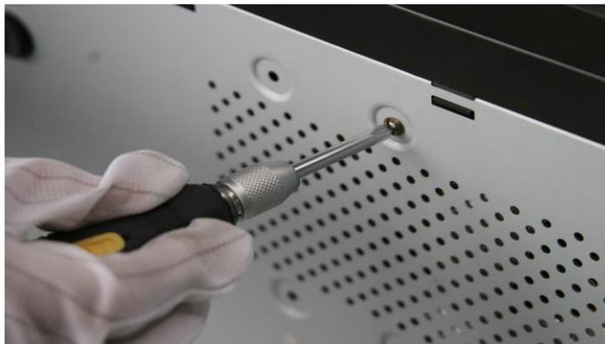
Рисунок 2.6 Удаление крышки
