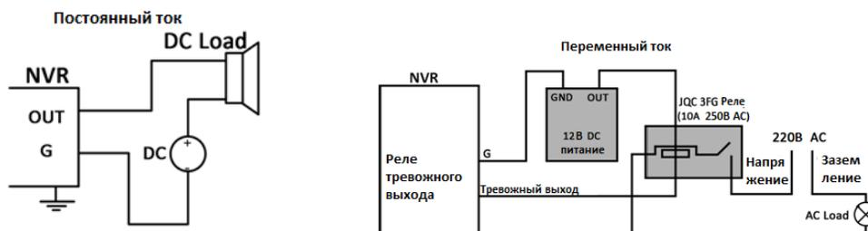
Рисунок 2.11 Подключение тревожного выхода
