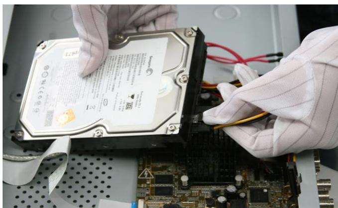
Рисунок 2.8 Подключение кабеля питания
