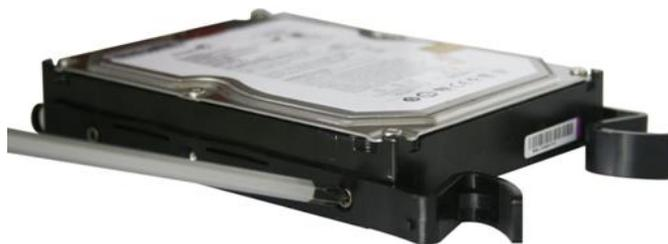
Рисунок 2.1 Закрепление салазок жесткого диска
