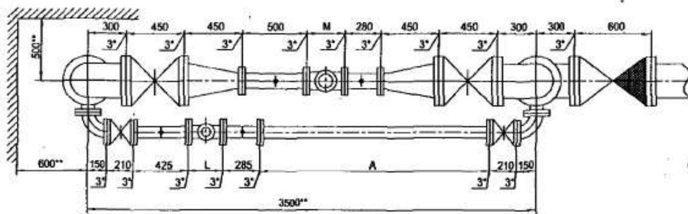
Установка счетчика фу=80 мм на хозяйственно-литьевой линии и счетчика фу=100 мм на пожарно-резервной линии в водометном узле на воде диаметром 250 мм.
