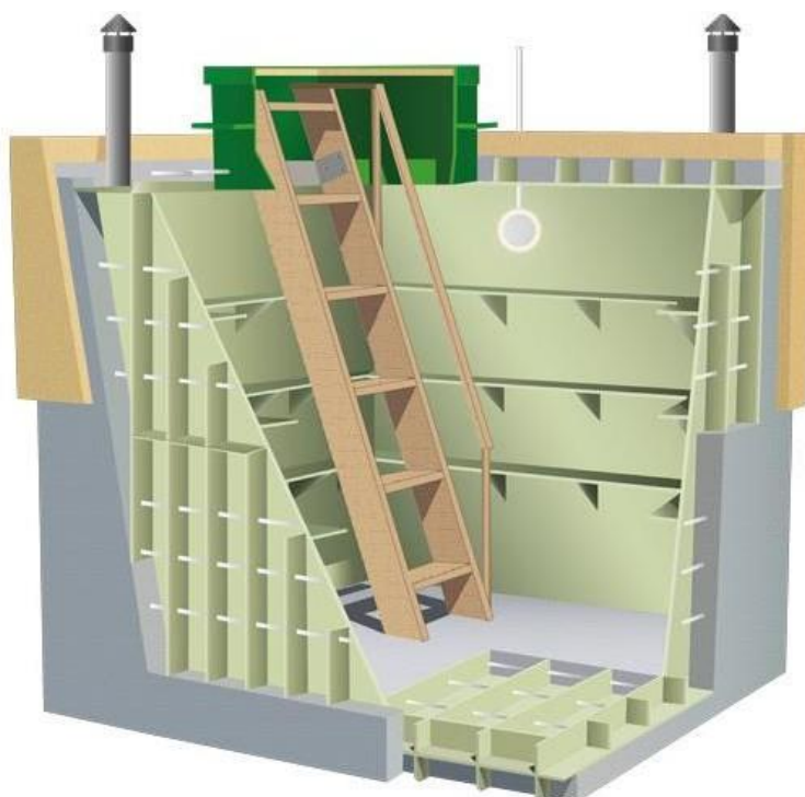
Рисунок 2. ГРИНЛОС Погреб в разрезе
