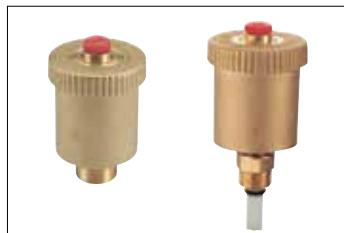
Автоматический воздухоотводный клапан (воздухоотводчик) R99 позволяет удалять газы и их смеси различных концентраций, образующиеся в процессе работы системы отопления. Эти газы могут вызывать сбои в работе системы отопления, такие как шумы, воздушные пробки, которые снижают эффективность работы источников тепла и способствуют коррозии металлических элементов.
