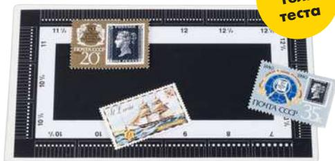
Прозрачный с обеих сторон зубцемер, предназначен для измерения размера и количества зубцов на марке. Для этого просто следует приложить марку к шкале и двигать до тех пор вверх или вниз, пока не будет найден ряд, в котором зубцы или точки точно совпадают с отверстиями перфорации. Запаян в пластмассовую оболочку. Наружный формат 153 x 80 мм.
