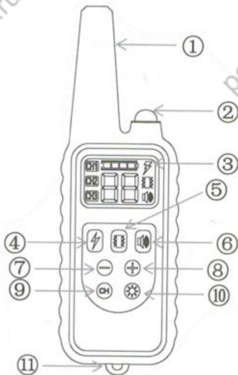
1. Антенна: заявленный производителем диапазон действия – до 800м
