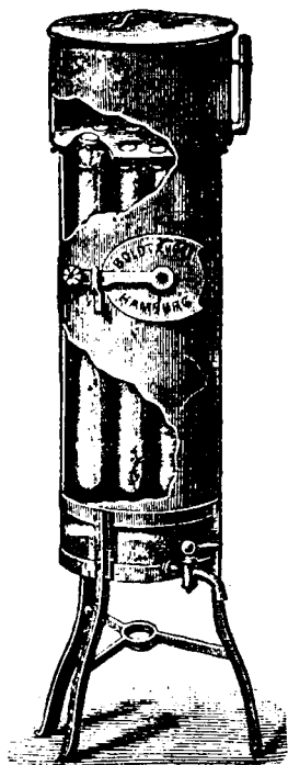
Рис. 30. Фильтръ съ фланелевыми мѣшками.
