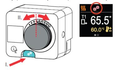
9.6. При неисправности датчика температуры на дисплее появляется сообщение о неисправности.
