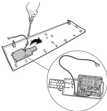
4. На плате управления дисплейным модулем найдите разъем подключения с маркировкой CN3. В случае предустановки в нее элементов коммутации, освободите его и подготовьте к установке Wi-Fi контроллера.
