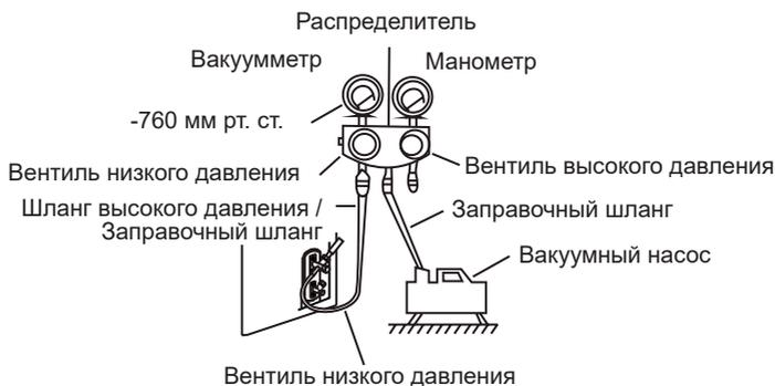
6. Закройте вентиль низкого давления распределителя и выключите вакуумный насос.
