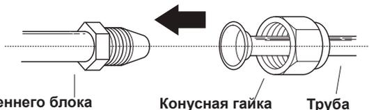
2. Затяните конусную гайку вручную до упора.
