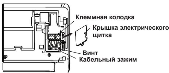
Вид сзади (для определенных моделей)
