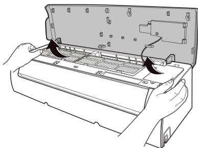
3. Открутите винт крепления и снимите корпус дисплейного модуля, вынув его из пластиковых зацепов для доступа к плате управления как на рис.2
