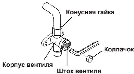
12. С помощью шестигранного ключа полностью откройте клапаны высокого и низкого давления.
