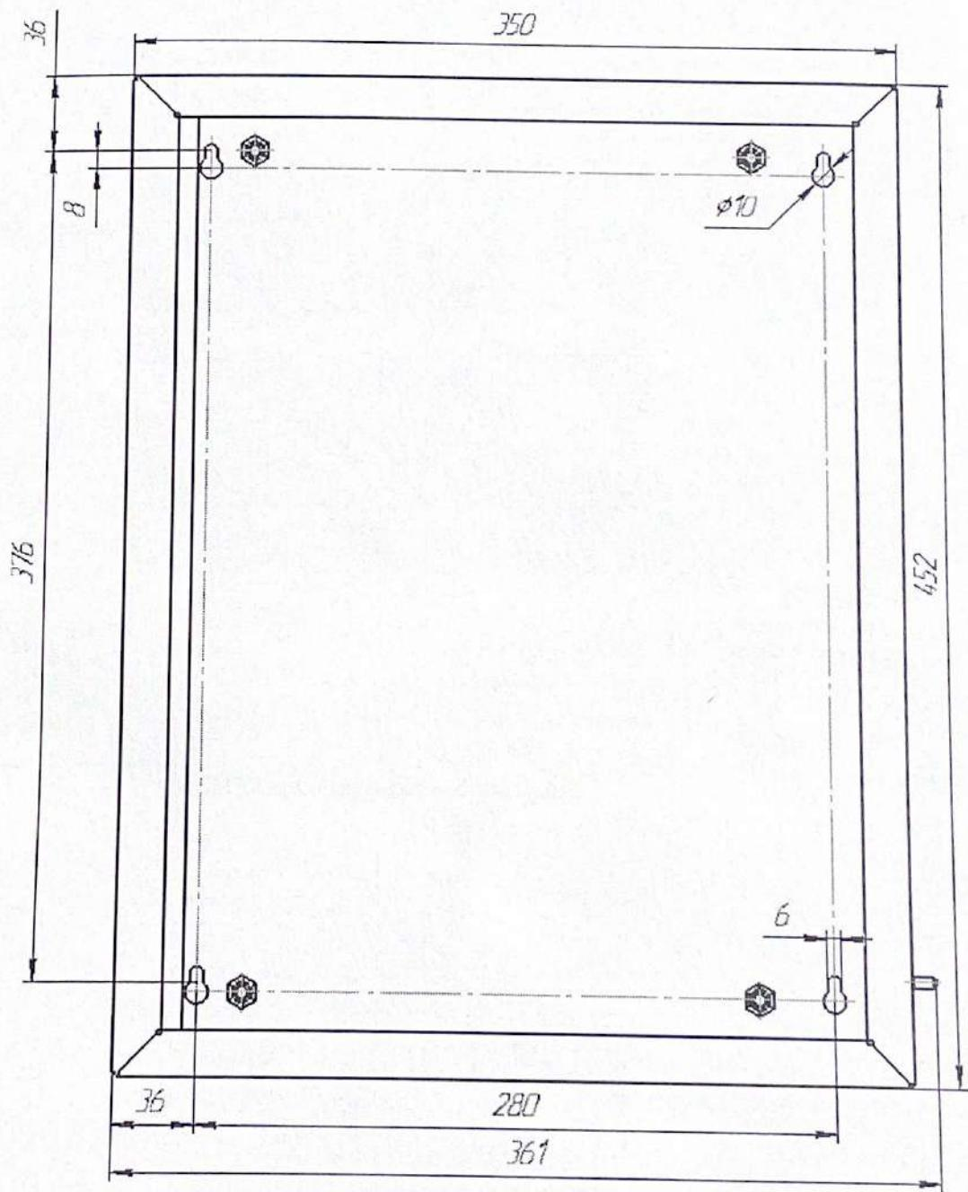
Рисунок 4 – Разметка крепежных отверстий
