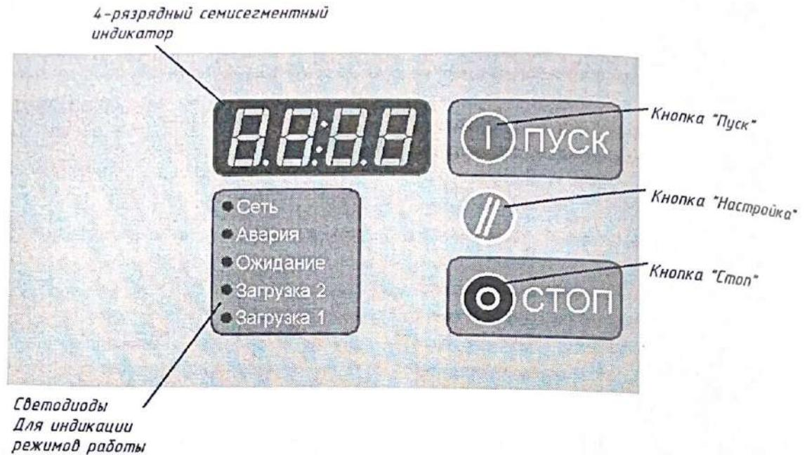
Рисунок 5 – Контроллер КПК-01
