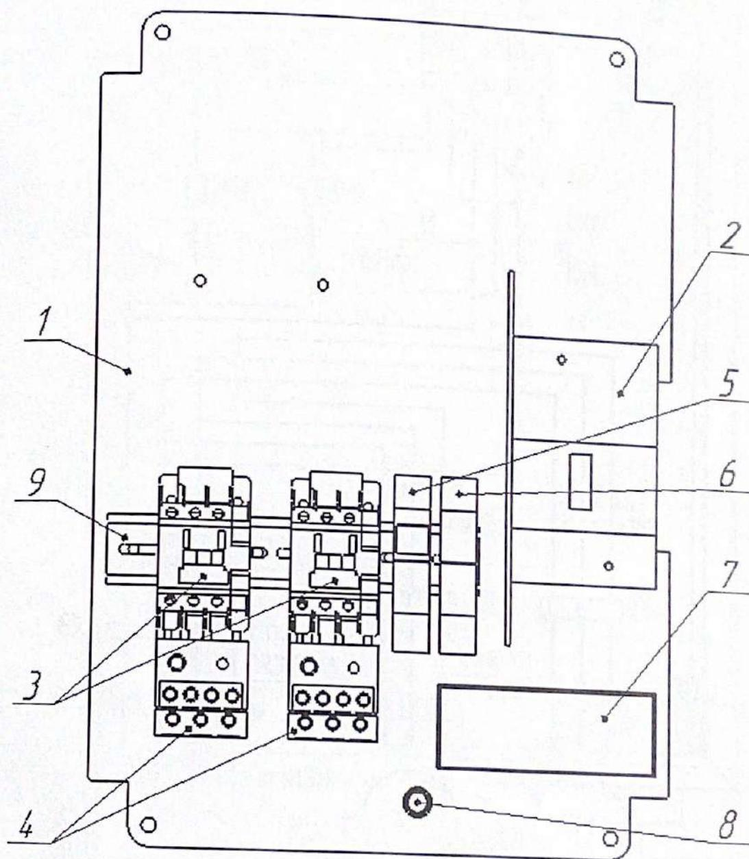
Рисунок 2 – Схема размещения аппаратуры на монтажной панели
