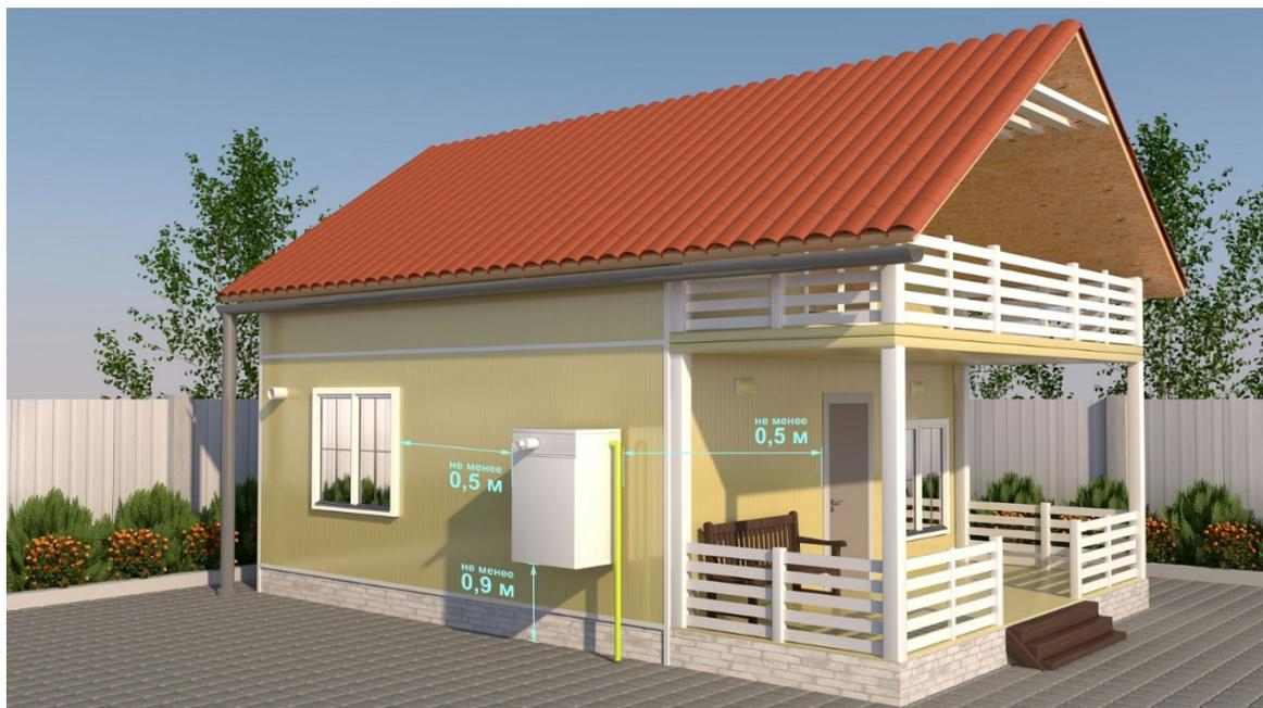
**Расстояние от дымохода до вентиляционных решеток на стене здания = 1,0 м;**
