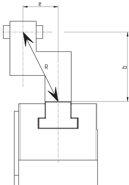
При условии, что центр масс захватываемого объекта часто смещен вверх на высоту губок (b) и иногда смещен вбок относительно оси движения губок (e), результирующий рычаг R по отношению к плечу (b) и эксцентриситету (e) может быть рассчитан по формуле:
