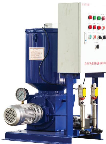
Станции и системы подачи густой смазки: двухлинейные, однолинейные и многолинейные
