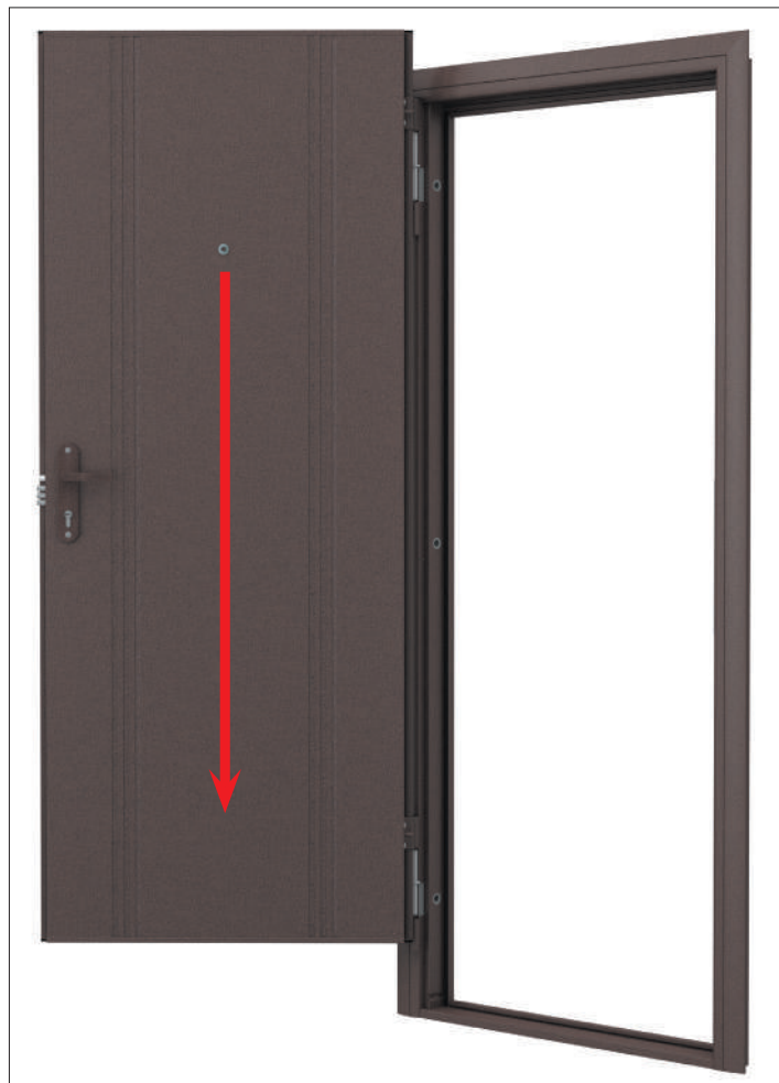
Навесьте полотно двери на раму.
