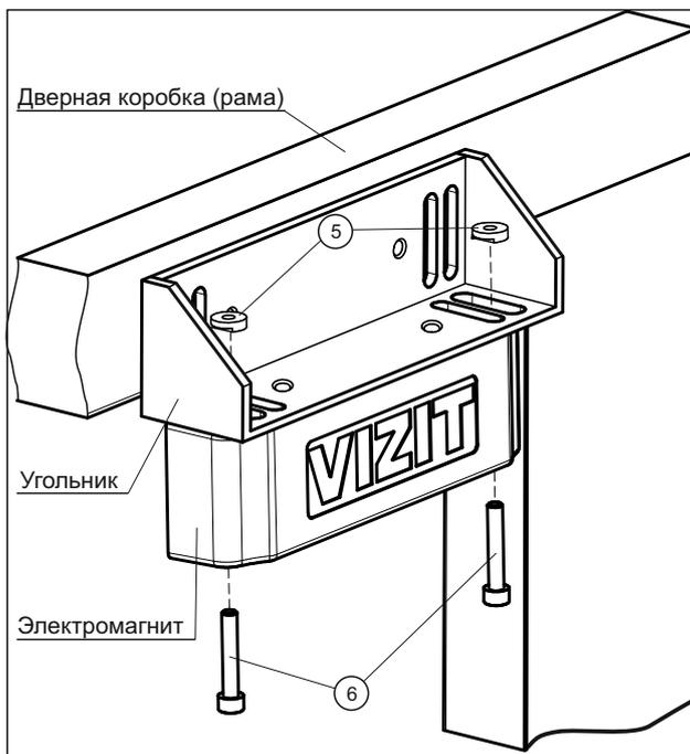
Рисунок 2 - Схема установки электромагнита на дверной коробке (раме)
