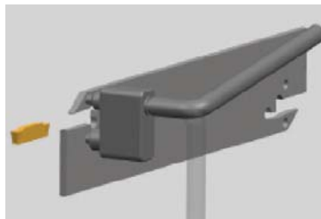
② Закрепите пластину в гнезде, до этого ослабив крепление поворотом ключа на 45° ~ 160°
