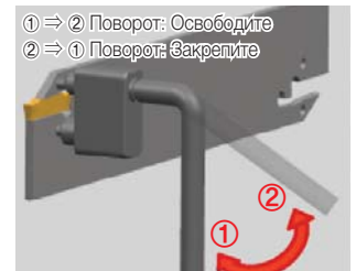
③ Поверните ключ и закрепите СМП, затем вытащите ключ из отверстия
