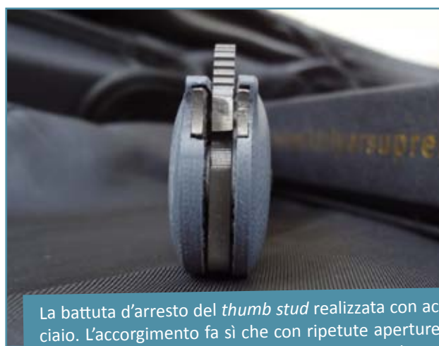
Dettaglio del sistema di chiusura liner lock del Biker Z: la chiusura è realizzata in modo esemplare, con accoppiamenti precisi che conferiscono robustezza al coltello che, in fase di apertura, non mostra alcun gioco della lama
