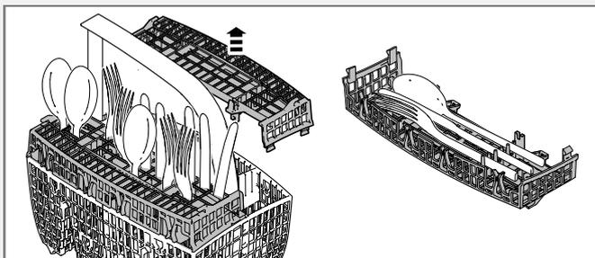
Крышку корзины для столовых приборов можно снять и использовать, например, в качестве дополнительной корзины, разместив в нее в верхней корзине (см. выше).
