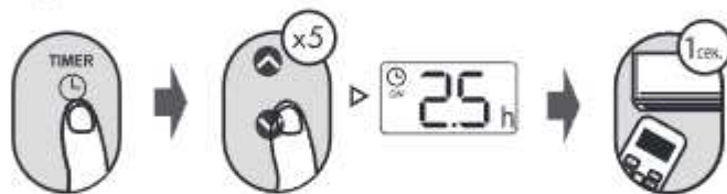
Пример: установка таймера на включение блока через 2,5 часа
