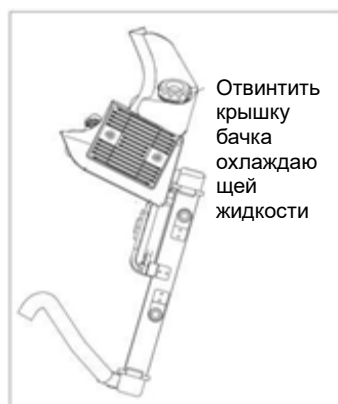
Рис. 34 Добавление охлаждающей жидкости
