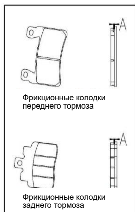
Рис. 26 Проверка фрикционной накладки переднего тормоза
