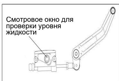
Рис. 31 Проверка уровня тормозной жидкости заднего тормоза
