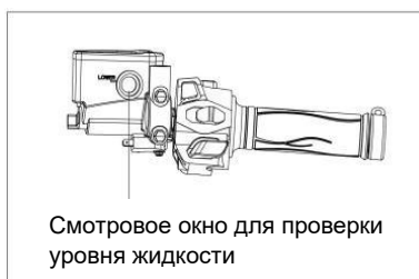
Рис. 27 Проверка уровня тормозной жидкости переднего тормоза
