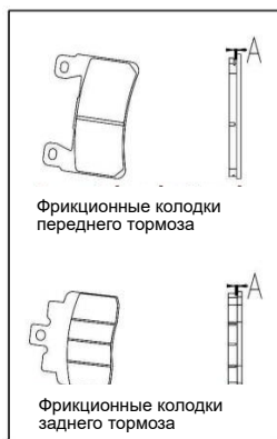
Рис. 30 Проверка фрикционной колодки заднего тормоза
