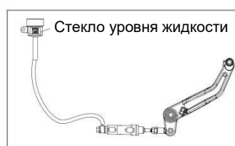
Рис. 30 Проверка уровня тормозной жидкости в системе заднего тормоза
