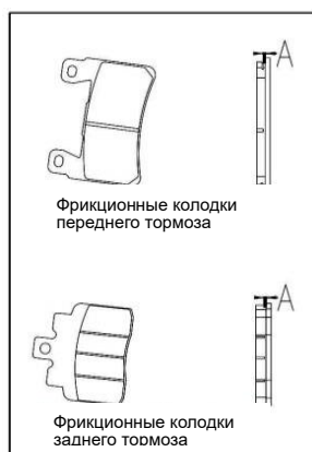
Рис. 29 Проверка фрикционной накладки заднего тормоза
