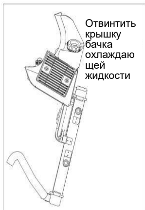
Рис. 33 Долив охлаждающей жидкости
