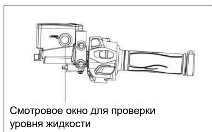
Рис. 26 Проверка уровня тормозной жидкости переднего тормоза
