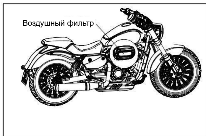
Рис. 18 Расположение воздушного фильтра
