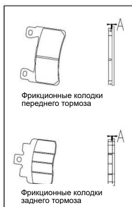
Рис. 25 Проверка фрикционной накладки переднего тормоза
