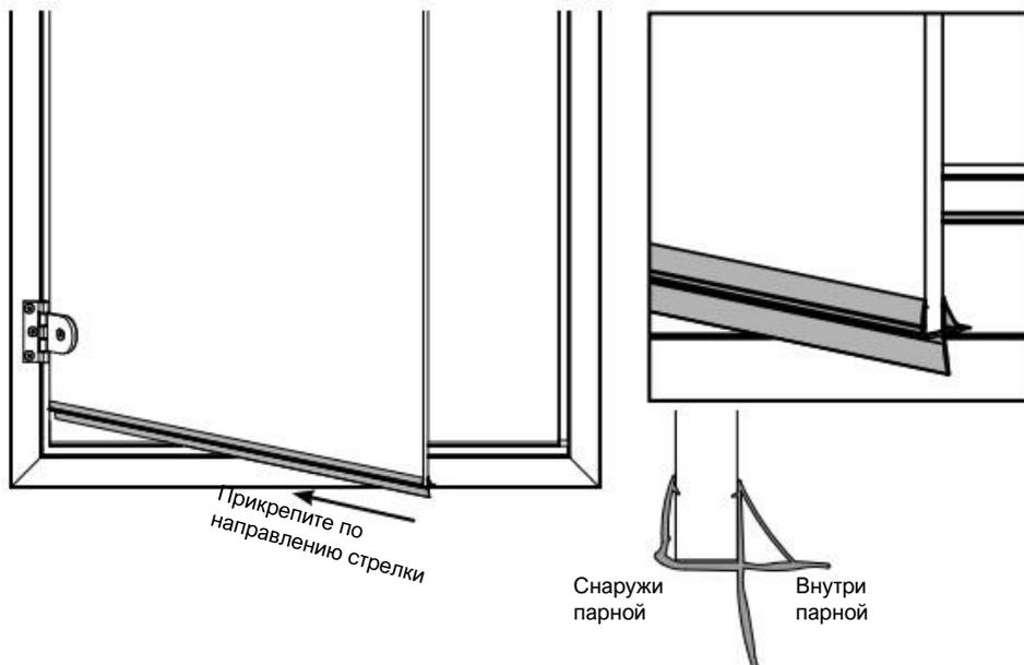
**6c** Нанесите на нижнюю часть дверной коробки герметик и прикрепите алюминиевый профиль
