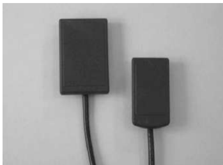
Рис. 2. Рентгеночувствительная ССD-матрица различных размеров в качестве приемника рентгеновского изображения
