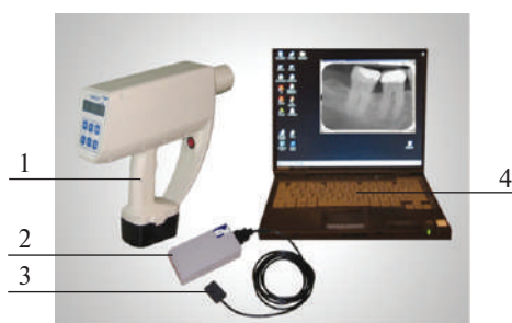
Рис. 1. Внешний вид портативного цифрового рентгенодиагностического комплекса «ПАРДУС-Стома»: 1 — микрофокусный рентгеновский аппарат «ПАРДУС-Р»; 2 — устройство для визуализации «РЕНТГЕНОВИДЕОГРАФ»; 3 — приемник рентгеновского излучения (ПЗС-матрица); 4 — персональный компьютер
