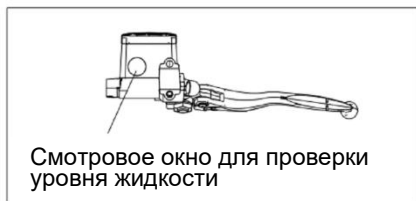
Рис. 28. Проверка уровня тормозной жидкости переднего тормоза
