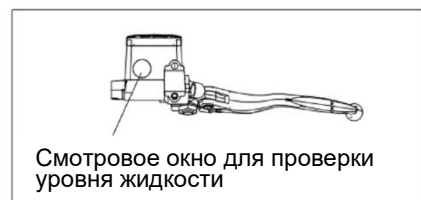
Рис. 32. Проверка уровня тормозной жидкости заднего тормоза
