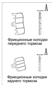
Рис. 27. Проверка фрикционных колодок переднего тормоза
