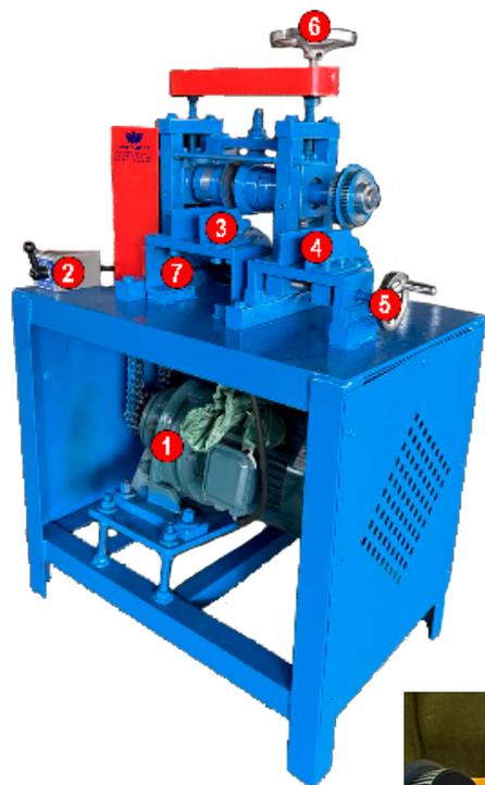
1. Мотор-редуктор 5.5 кВт
