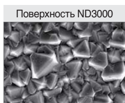
Поверхность ND3000 Высокая твердость алмазного покрытия (Hv 10000) обеспечивает превосходную износостойкость
