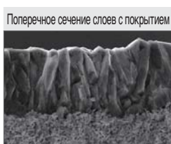
Поперечное сечение слоев с покрытием Специальный сплав для обработки циркония обеспечивает отличную адгезию
