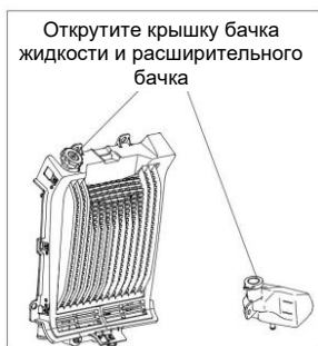
Рис. 35 Добавление охлаждающей жидкости
