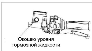
Рис. 28 Проверка уровня тормозной жидкости переднего тормоза
