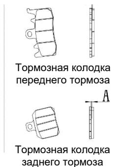
Рис. 27 Проверка тормозных колодок
