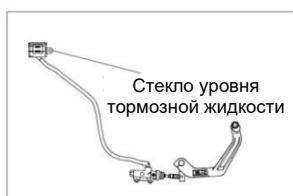
Рис. 32 Проверка уровня тормозной жидкости заднего тормоза
