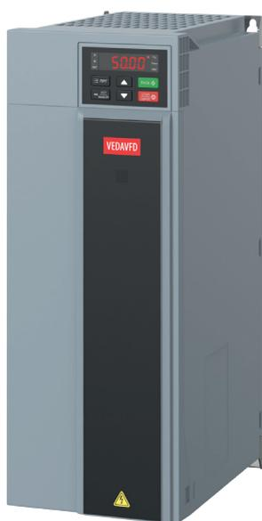
**Серия VF-101** — преобразователи частоты для систем отопления, вентиляции и кондиционирования, а также насосов, общепромышленных применений, в том числе с тяжелыми пусками. Привод предназначен для работы в сетях питания 1x220В, 3x380В, 3x660В и мощностью от 0,75 до 1120 кВт, возможно исполнение с нормальной и высокой перегрузкой. Привод имеет встроенный сетевой интерфейс RS-485. Частотный преобразователь VF-101 может управлять асинхронными и синхронными двигателями.
