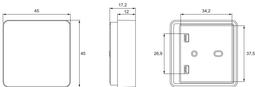
Датчик протечки воды Wiser
