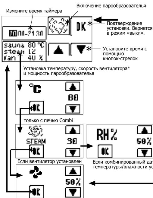
нажмите на кнопку парогенератора, чтобы включить парогенератор и нажмите на время на экране, чтобы изменить время таймера. Внесите изменения с помощью кнопок-стрелок. Нажмите на кнопку «sauna, steam, fan», чтобы установить температуру сауны, скорость вентилятора и мощность парогенератора. Нажмите на кнопку «OK» или подождите 5 секунд, чтобы перейти на следующий экран. Потом нажмите на кнопку «OK», чтобы вернуться в режим «выкл.»
