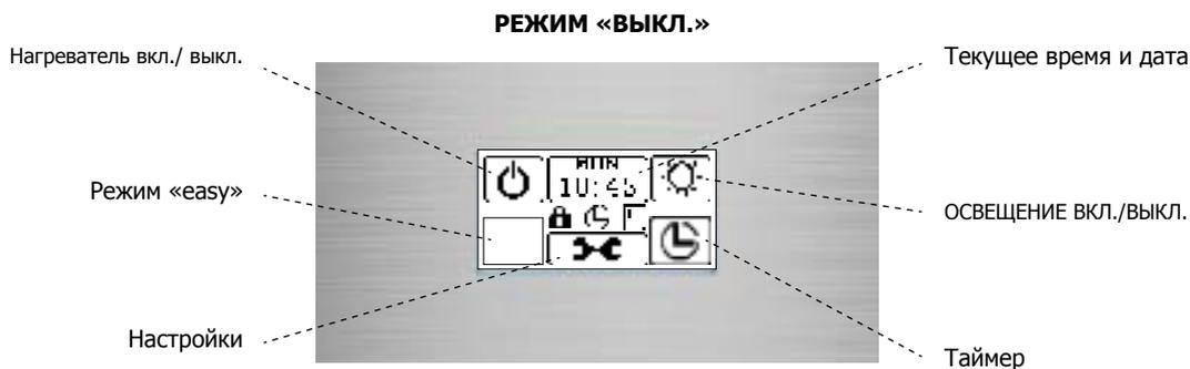
В режиме «easy» некоторые из кнопок не отображаются. Поэтому в этом режиме Innova легко и просто использовать. Чтобы активировать режим «easy», нажмите и удерживайте спрятанную кнопку в течение 10 секунд. В режиме «easy» можно использовать нагреватель, парообразователь и освещение.
