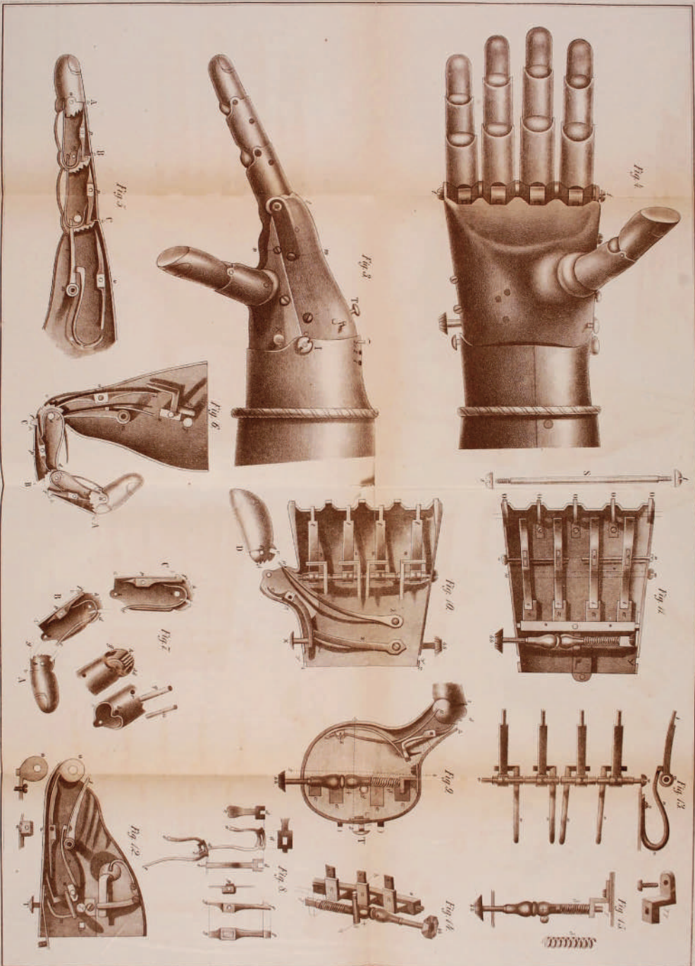
Die eiserne Hand des Killers. Holz von Berchtolden nach ihrem innern Mechanismus und allen zu demselben gehörenden einzelnen Theilen.
