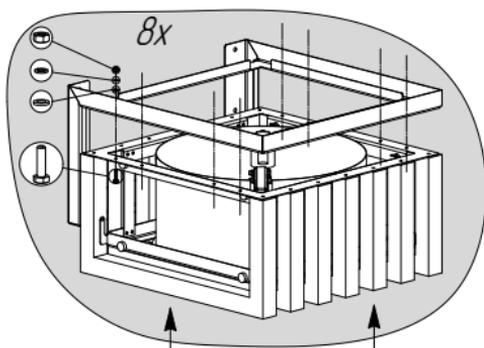
**3.3.** При креплении устройства (1) к потолку разметьте места крепления на потолке, учитывая размеры изделия. Закрепите устройство (1) на потолке с помощью необходимых крепежных элементов (не входят в комплект поставки).
