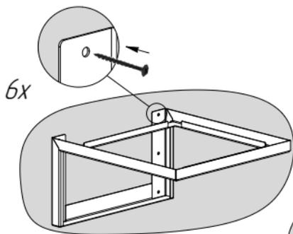
При необходимости определения горизонтали и вертикали используйте строительный уровень. Закрепите кронштейн (7) на стене, используя необходимые крепежные элементы (не входят в комплект поставки).
