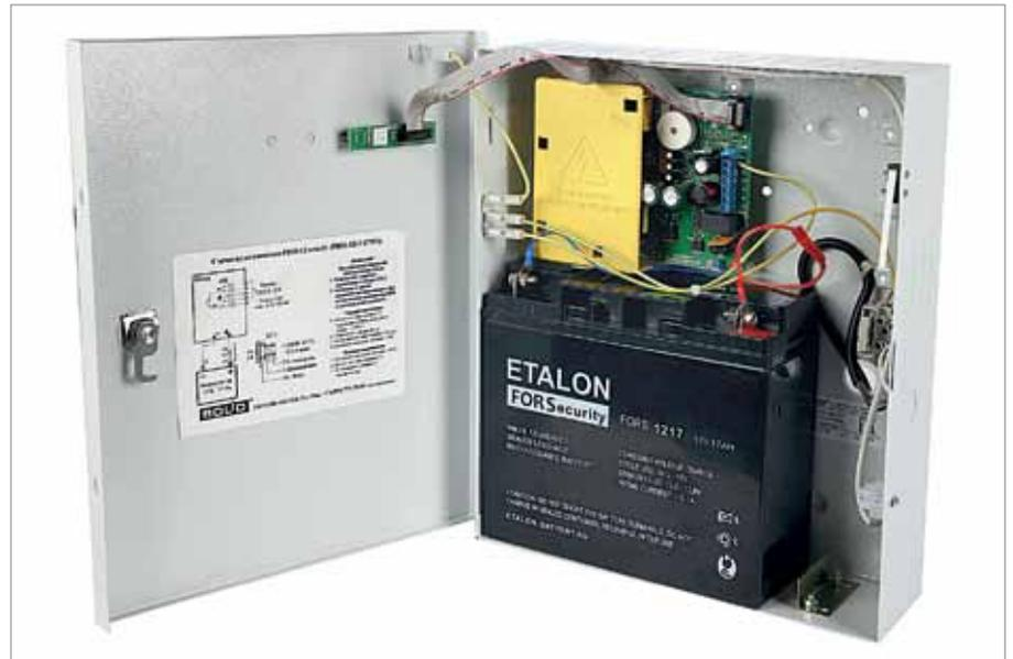
Фото 2. Аккумуляторы ETALON серии FORS широко используются в охранных системах
