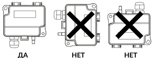
Рисунок 1с - Прикладные соединения
