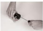
Расположите отверстия с соответствующими значками горизонтально и вставьте перо отвёртки в паз соответствующего размера. Затачивайте инструмент, периодически проверяя результат.
