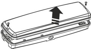
**2** Отожмите защелки на панели со светодиодной матрицей, откиньте панель.
