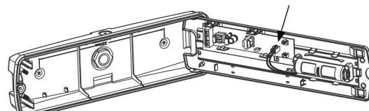
**6** Соберите светильник в обратной последовательности. Включите питание светильника и проверьте, горит ли зеленый светодиодный индикатор, чтобы подтвердить зарядку батарей. При первом использовании, после непрерывной зарядки в течение 24 часов, следует имитировать сбой в сети, чтобы убедиться, что светильник работает в течение указанного времени (только в безопасное и подходящее время).
