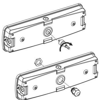
**4** Заведите в корпус кабель сетевого электропитания через герметичный кабельный ввод. Закрепите светильник. Расстояние между креплениями 220мм.
