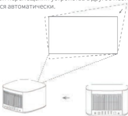
Если в зоне проецирования есть препятствия, то при включенной функции автоматического обхода препятствий автоматически выбирается место проецирования кадра с обходом препятствия. Когда включена функция автоматической подстройки под экран, кадр будет автоматически вписываться в экран, если в области проецирования есть экран с соотношением сторон 16:9 или 16:10.
