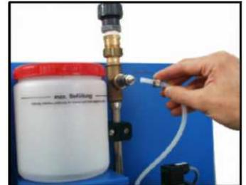
При первом заполнении емкости ароматизатора в крышку насоса автоматически поступает воздух. В целях обеспечения надежной работы насоса воздух необходимо откачать. Для этого необходимо снять шланг насоса с дозирующего клапана (см. рис.). При всех последующих дозированиях ароматизатора выкачивать воздух из насоса не нужно!
