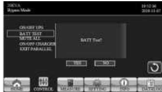
Проверка аккумуляторной батареи.
