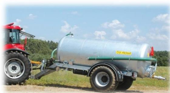
Ассенизационные машины компании PRONAR 6000 л оборудованы внутри резервуара по его периметру приварены кольцевые поперечные элементы для повышения жесткости. Бак имеет сварную внешнюю и внутреннюю конструкцию, покрытие нанесено методом горячего оцинкования (как и на раму ассенизационной машины) что дополнительно повышает его стойкость.
