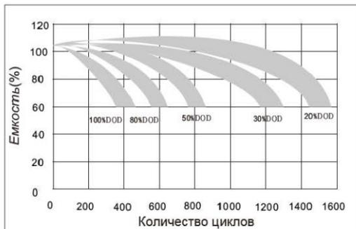
Рис. 5. Влияние глубины разряда на циклический ресурс
