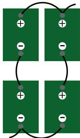
Последовательное / параллельное подключение
