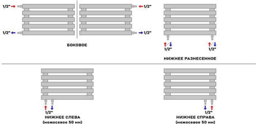
**Axxinot Fortalla V - вертикальный трубчатый стальной радиатор с квадратным профилем трубы 40 мм на 40 мм.**
