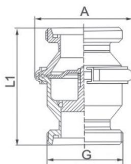
**Размеры клапанов QCV с присоединением CLAMP/CLAMP по DIN 32676 модель 2013**
