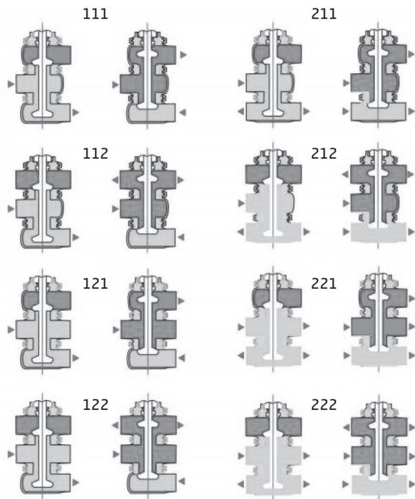
**Конструктив односедельных клапанов Серии QRV-SS**
