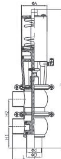
Клапаны односедельные Серия QRV-SS – габаритные размеры
