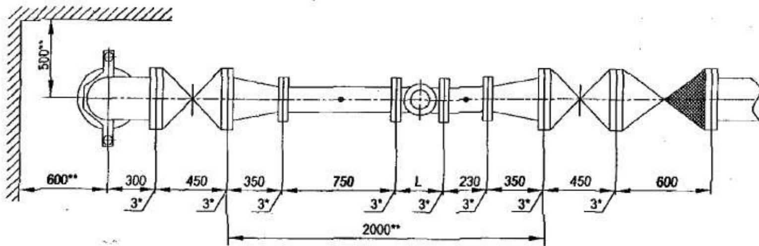
Установка счетчика ду=150 мм в водомерном узле
