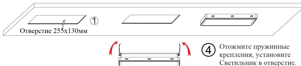
④ Отожмите пружинные крепления, установите Светильник в отверстие.
