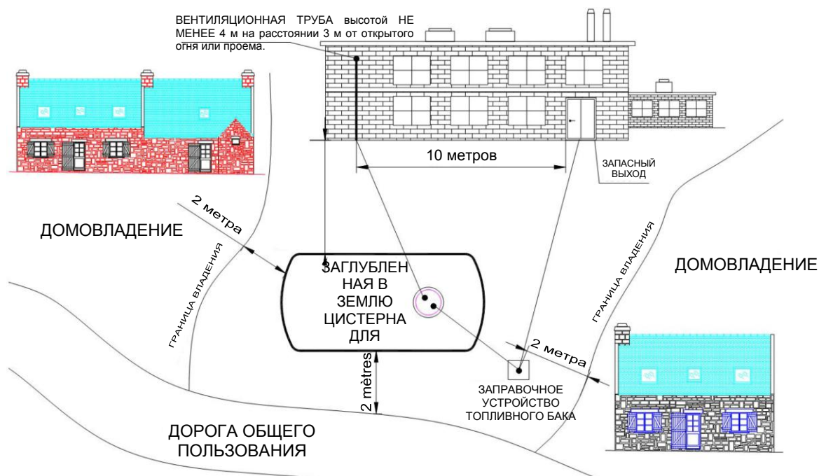
Рисунок 40: Пример размещения топливной цистерны во Франции
